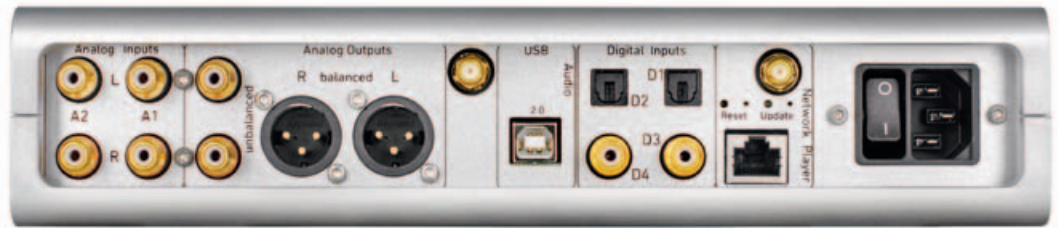
Auf der Rückseite bleiben keine Wünsche offen: Digitale Zuspiegelung ist über USB, Netzwerk und S/PDIF möglich, außerdem gibt es zwei analoge Cinch-Eingänge. Antennenanschlüsse sorgen für drahtlose Konnektivität (Bluetooth, WLAN). Die symmetrischen XLR-Ausgänge sind für Aktivboxen gedacht.
