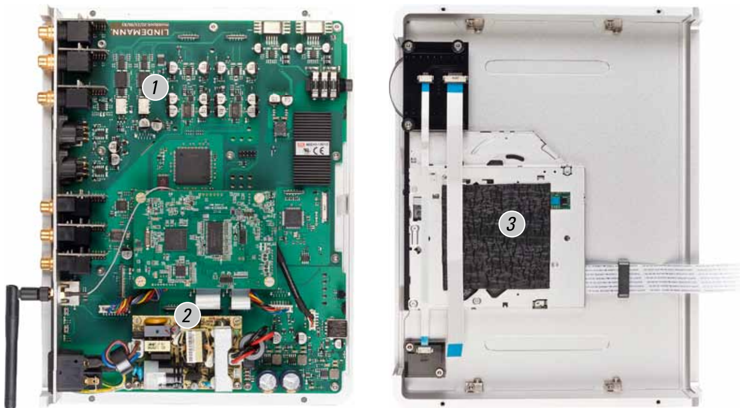
Lindemann nutzt den Platz im Musicbook:25 ordentlich aus und packt das CD-Laufwerk von TEAC unter die Oberschale. (1) Der untere Gehäuseteil umfasst die Hauptplatine, zu deren wichtigsten Bestandteilen der digitale Signalprozessor gehört. (2) Nach erfolgreichem Digitalsignal-Upsampling erfolgt die Digital-nach-Analog-Umsetzung mittels zweier WM8742-Wandlerchips von Wolfson. (3) Beide empfangen Signale von bis zu 32-Bit- und 384-Kilohertz-Auflösung. Der analoge Signalweg bleibt unter dessen vollkommen unberührt
